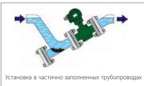
Расходомер устанавливается электронным блоком ВВЕРХ
